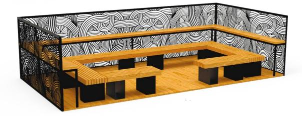
Опоры: Металлический каркас, Покрытый порошковой полимерной краской. Декоротивная обшивка деревом
