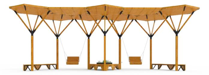
Опоры: Брус из хвойных пород, соединенный металлическими коннекторами Крыша: Брус, поликорбанат
